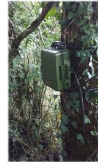
Figure 222 : Installation d'enregistreur continu SM4BAT © NCA Environnement
